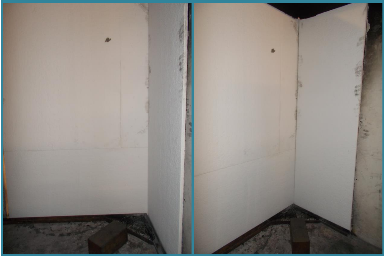
Fig.1 – Campione N. 1 – Primo piano dei pannelli, lato lungo e lato corto a un'altezza di 500 mm dal pavimento del carrello
